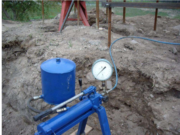
8.3 pav. Rankinė hidraulinė siurblinė
